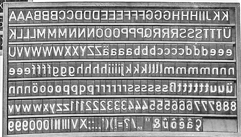
Abb. 35 Erweiterter Schriftsatz DIN 1451/IV Mittelschrift, erhaben, Spiegelschrift
