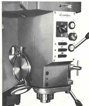
GILLARDON-Frontplatte mit Gewindeschneidautomatik
