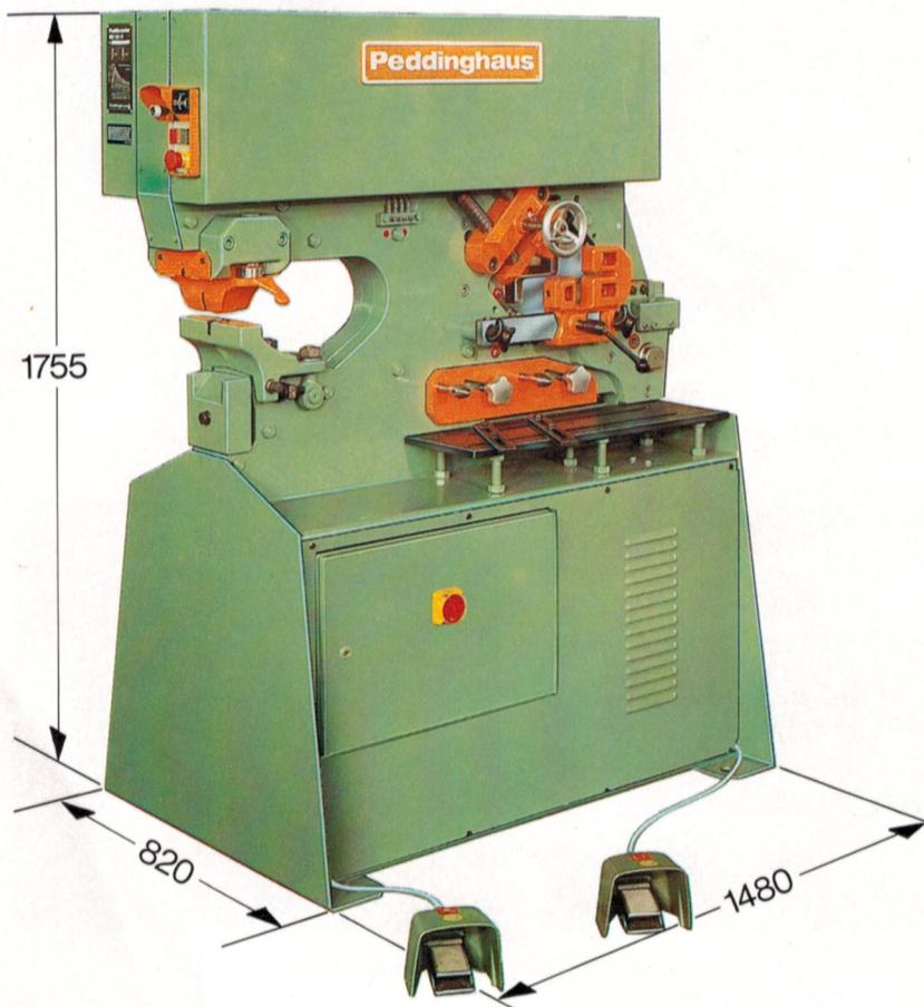
**Peddimaster 80/110:** 800 kN Stanzkraft, 1100 kN Scherkraft, vierfach kombiniert mit Flach- und Profilstahlschere, Ausklinker und Lochstanze, 510 mm Stanzausladung, integrierter hydraulischer Antrieb.
