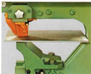
**2** Lochstanze mit besonders großer Ausladung und hoher Stanzleistung; dadurch können auch große, sperrige Werkstücke leicht bearbeitet werden.
