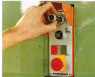
**4** Hydraulischer Taktsucher für exaktes, präzises Stanzen.
