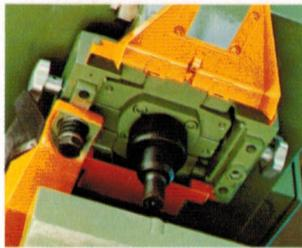
**3** Großer, präzis geführter Stanzschlitten; ideal auch für die Aufnahme von Sondervorrichtungen.
