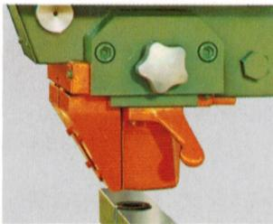
**1** Der stabile Abstreifer an der Lochstanze ist höhenverstell- und abschwengbar; dadurch lassen sich die Werkzeuge schnell wechseln.
