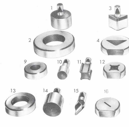
7h Schnellwechsel-Werkzeugsätze Diese erlauben ein schnelles und einfaches Auswechseln von Stempel und Matrize durch automatische Schnittspielzentrierung beim Einspannvorgang.
